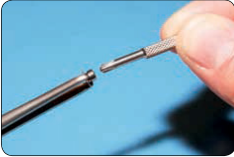
7: Einstellen der Haltekraft mit dem Aktivator.
