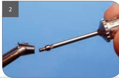
2 Für die ICX-multi Aufbau Prothetik gibt es spezielle Okklusalschrauben. Dafür wird das Sechskantinstrument SW 1,2mm benötigt.
